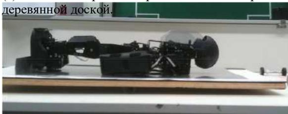
(c) Уравновешивание деревянной доски путем сдвигания алюминиевой пластины.
